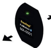
Activez votre FxMotion: Placez-le à la verticale et secouez-le horizontalement. La led verte confirme que l'appareil est activé.
