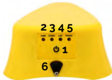
**2. PWR** : indique que l'appareil est allumé, et devient rouge lorsque la batterie est faible.
